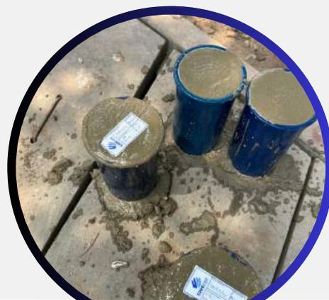
ELABORACIÓN DE PROBETAS EN OBRA
